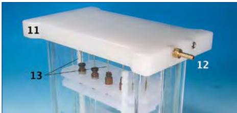
Abb. 4: Trockenaufsatzdeckel
