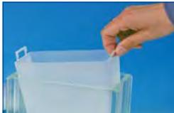
Um überschüssige Lösemittel zu sammeln, platzieren Sie den Tank in dem Glastrog. Nach dem Aufsetzen des Deckels und der Bestückung mit SPE-Kartuschen können Sie mit der Probenvorbereitung beginnen.
