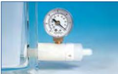
Das Vakuum darf 20 inch Hg (68 kPa, 680 mbar, 510 Torr, 0,66 atm, 0,67 bar, 9,8 psi) nicht unterschreiten. Bei Missachtung verfällt die Gewährleistung auf das ganze System. Zwischen 25–27 inch Hg (84–91 kPa) wird ein für die meisten Anwendungen ausreichendes Vakuum für CHROMABOND® SPE-Säulen erzielt. Wenn die Auffanggefäße gewechselt werden müssen, kann durch Schließen des Rings am Regulierventil das Vakuum pumpeitig gehalten werden.
