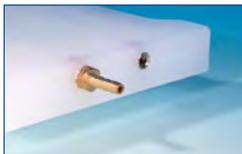
Mit Hilfe von Adaptern kann der Trockenaufsatzdeckel auch dazu benutzt werden, die SPE-Kartuschen vor der endgültigen Elution zu trocknen.
