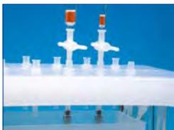
2. Vor der endgültigen Elution Ihrer Zielkomponenten nehmen Sie den Deckel von der Kammer und entfernen den Tank mit dem überschüssigen Lösemittel.
