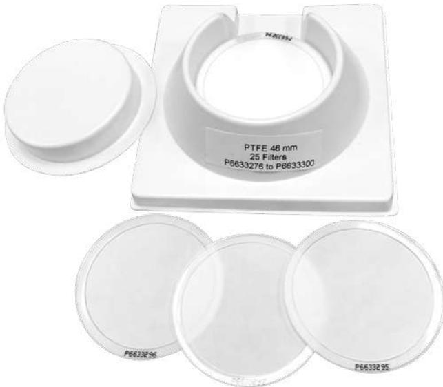
Die PM 2.5 PTFE-Membran von GVS ist eine hochreine, dünne Membran für die Umgebungsluftüberwachung von PM 2.5. Jede Membran ist fortlaufend mit einem chemisch resistenten Stützring aus Polypropylen nummeriert. Die geringe Eigenmasse ermöglicht eine genaue gravimetrische Bestimmung. Bei der Herstellung der Membranen werden keine Leime oder Klebstoffe verwendet, und durch das stabile Design wird das Kräuseln vermieden, so dass die Membran flach bleibt und Roboteranwendungen möglich sind.
